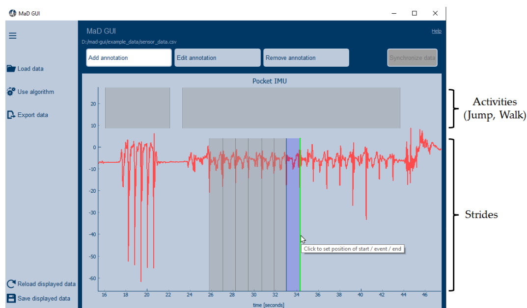
Abbildung 11: Hauptfenster der MaD GUI mit geöffneter Seitenleiste, für Plugin-Auswahl und aktiven Annotationsmodus. Im Beispiel werden im oberen Bereich des Plots Aktivitäten markiert, während darunter einzelne Schrittabschnitte hervorgehoben sind [35].
