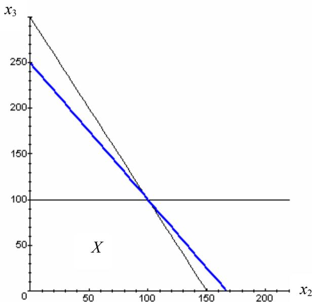
Die Zielfunktion zum optimalen Niveau  $z = 700$  ist dick gezeichnet, und die optimale Lösung ist  $(x_2, x_3)^T = (100, 100)^T$ .
