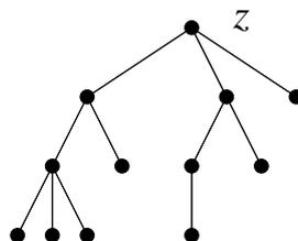
Der Code  $((00)0)0$  zum linken Kind der Wurzel ist lexikographisch sortiert, da  $((00)0) \leq ()$ . Der Code  $((00)0)$  zum mittleren Kind der Wurzel ist lexikographisch sortiert, da  $((00)0) \leq ()$ . Daher ist der Gesamtcode lexikographisch sortiert, da auch noch
