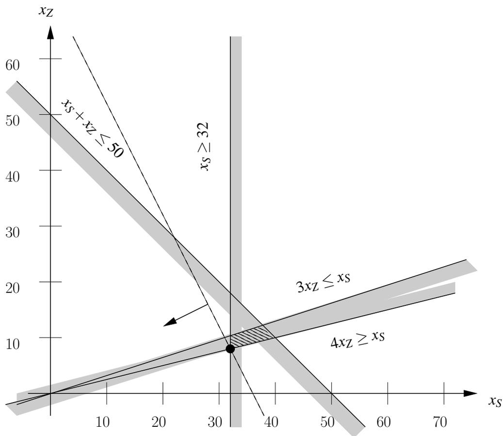
Die Optimallösung liest man ab als  $(32, 8)$ . Sie deckt sich erfreulicherweise mit der aus der 1. Lösungsmöglichkeit.
