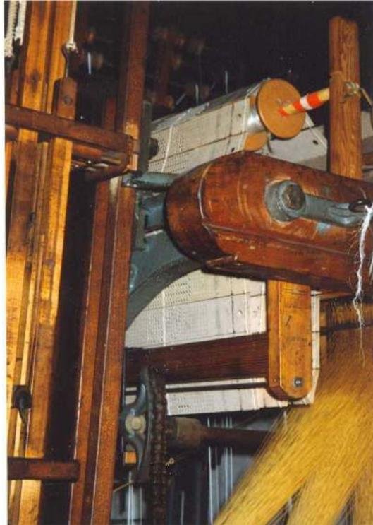
Abbildung 1.1: Die Lochkartensteuerung der Jacquard-Maschine.
