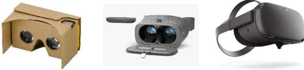
Abbildung 1.34: Smartphone Technologie in mobilen VR Headsets (v. l. n. r.): Google Cardboard (2014), Google Daydream View (2016), Oculus Quest (2019). Die ersten beiden Beispiele benötigten noch ein separates Smartphone, welches in eine Halterung vor die Linsen gesteckt wurde. Das Headset der Oculus Quest war bereits eine autarke Variante mit integrierter Smartphone-Technologie.
