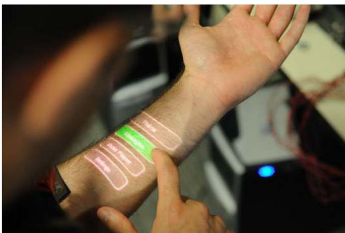
Abbildung 1.35: Skinput. In der Konzeptstudie „*Skinput*“ wird die Haut als Interaktionsmedium genutzt. Hierbei wird ein Menü über einen mobilen Projektor auf die Haut projiziert und die Eingabe des Fingers über ein Feld von Vibrationsensoren am Oberarm detektiert.
