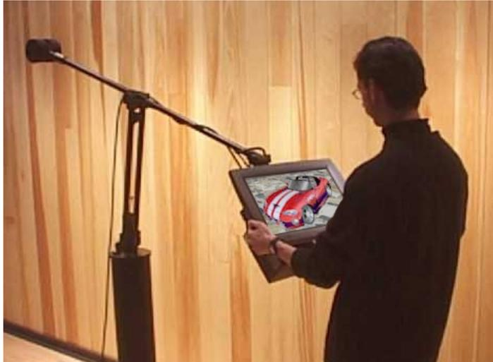
Abbildung 1.30: Boom Chameleon. Es ermöglicht die intuitive Steuerung der Perspektive auf eine dreidimensionale Darstellung.
