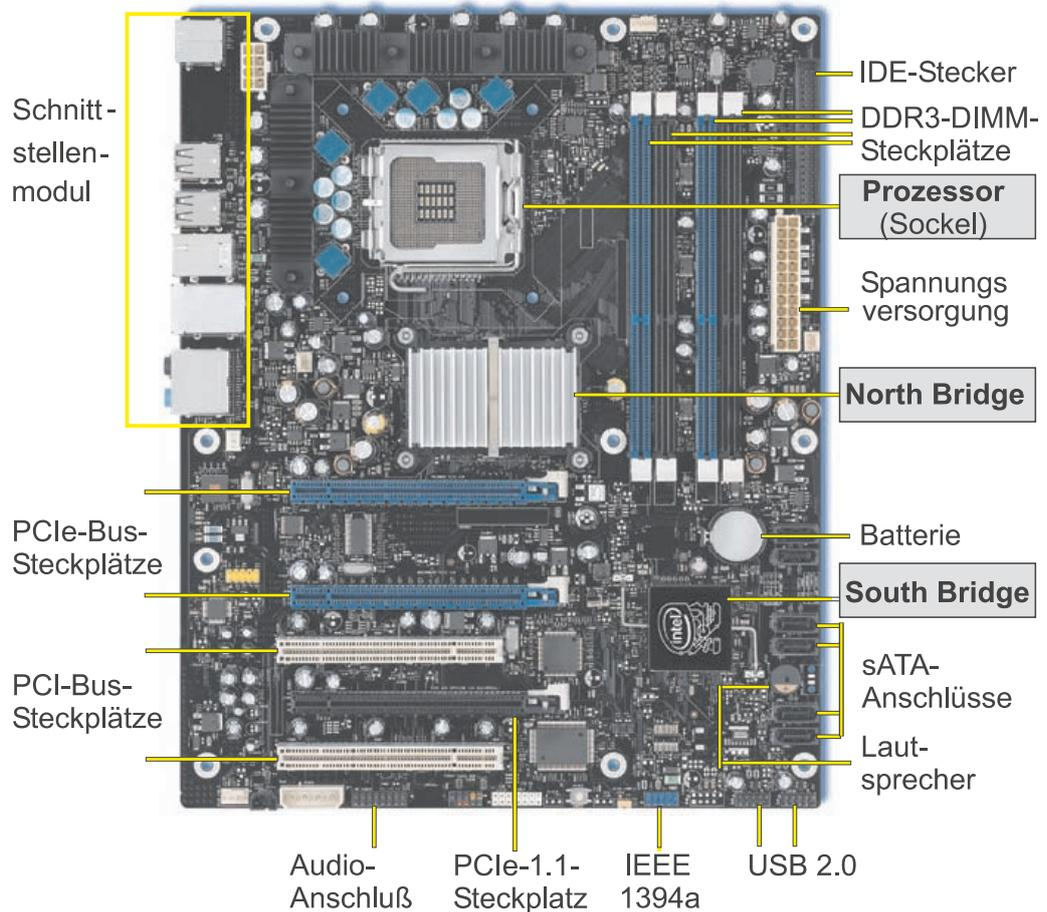
Abbildung 1.4: Photo einer Hauptplatine (*Intel Desktop Board DX48BT2*).
