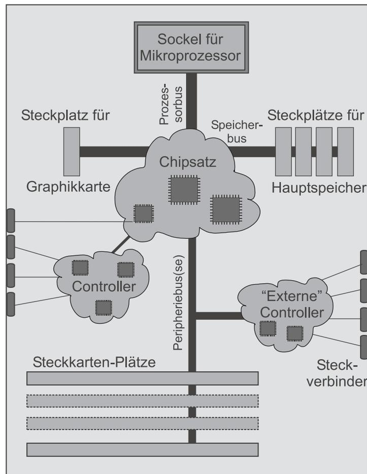
Abbildung 1.3: Der prinzipielle Aufbau einer Hauptplatine.
