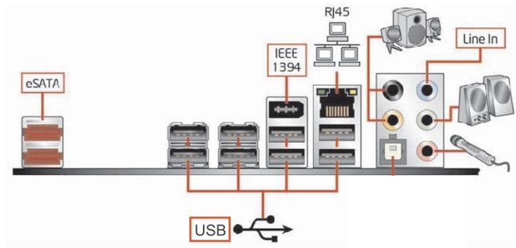
Abbildung 1.7: Ein Schnittstellenmodul.
