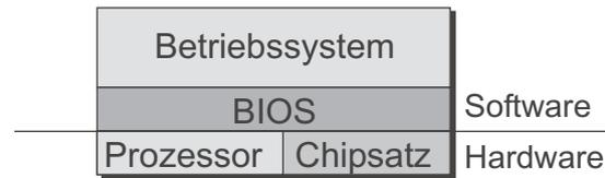
Abbildung 1.5: Das BIOS zwischen Betriebssystem und Hardware-Bausteinen.
