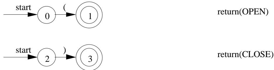
**Abb. 2.2.** Zustandsdiagramme für die Token OPEN und CLOSE
