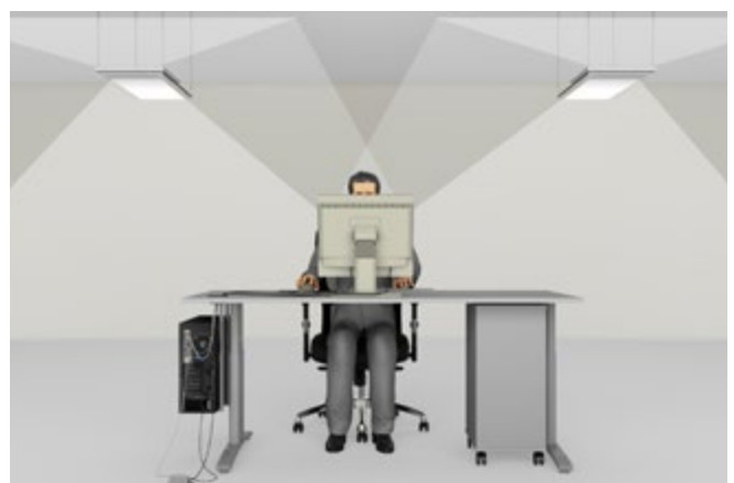
Abb. 46 Beispiel für Direkt-/Indirektbeleuchtung
